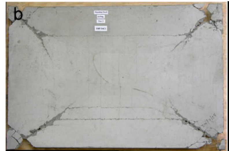
Fallo por compresión del hormigón
